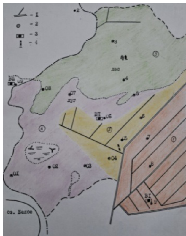
Рис. 1. План-схема локального водосбора гидромелиоративной системы «Вожа»: 1 – осушительная сеть; 2 – скважины для измерения глубины залегания грунтовых вод; 3 – водобалансовые площадки с лизиметрами и испарителями; 4 – водомерный пост с водосливом
