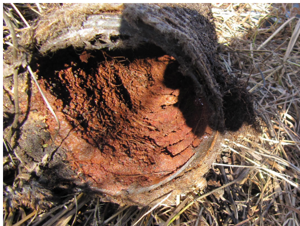
Рис. 2. Заохривание с заилением внутренней полости дрены № 103
