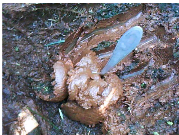
Рис. 5. Типичные песчано-охристые отложения в устьевом лотке крупным планом
