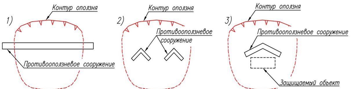
Рис. 4. Противооползневые сооружения, удерживающие весь оползневой массив, создающие стесненные условия, защищающие отдельный объект
