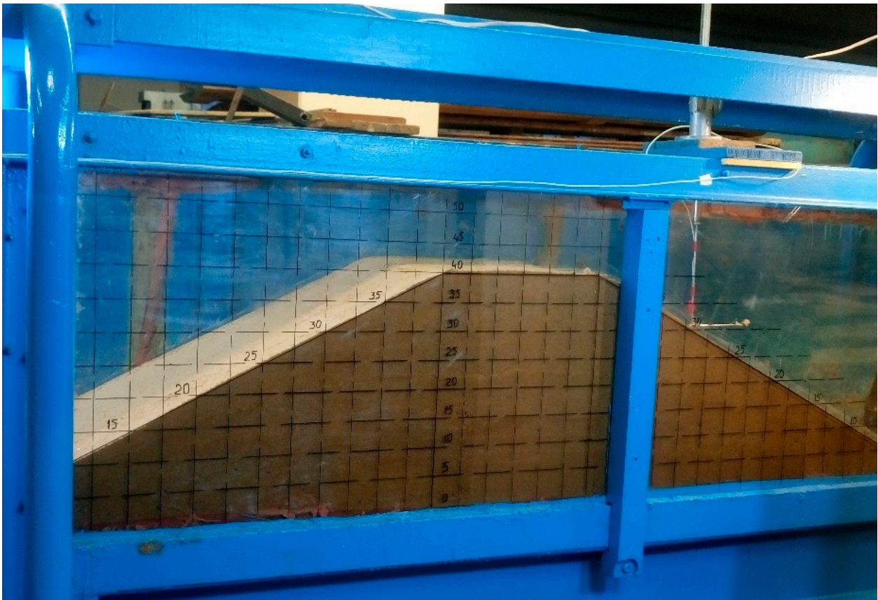
Рис. 1. Лоток с размещенной моделью плотины
