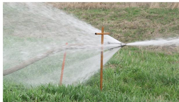
Рисунок 9 – Струи воды, исходящие из головки промывочной
