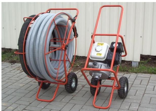
Рисунок 1 – Установка промывки устьевой части коллектора УПК-30
