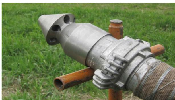
Рисунок 8 – Установка головки промывочной на пожарном рукаве
