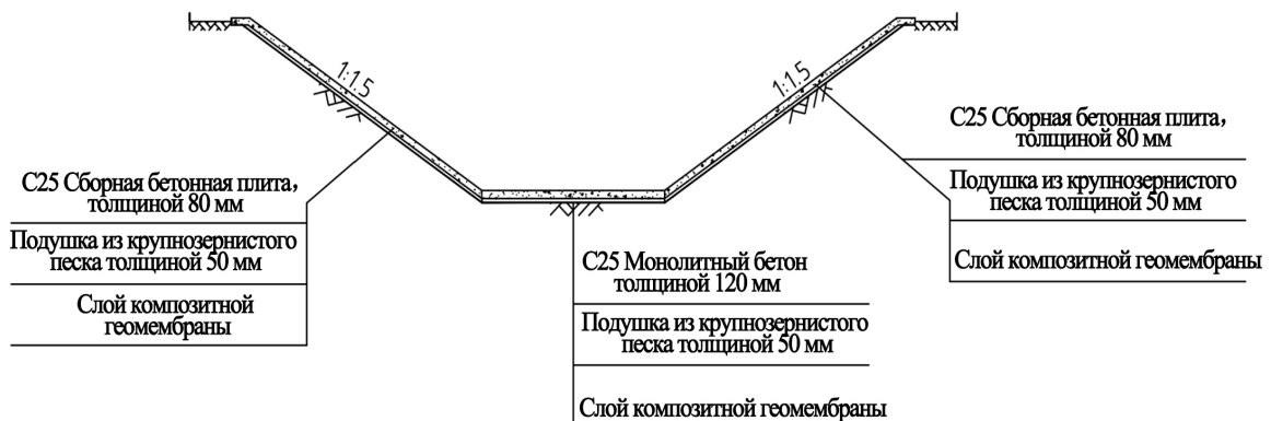
Рис. 6. Крепление откосов сборными бетонными плитами по слою геомембраны
