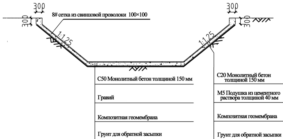
Рис. 5. Крепление канала непроницаемыми бетонными плитами на слое композитной геомембраны
