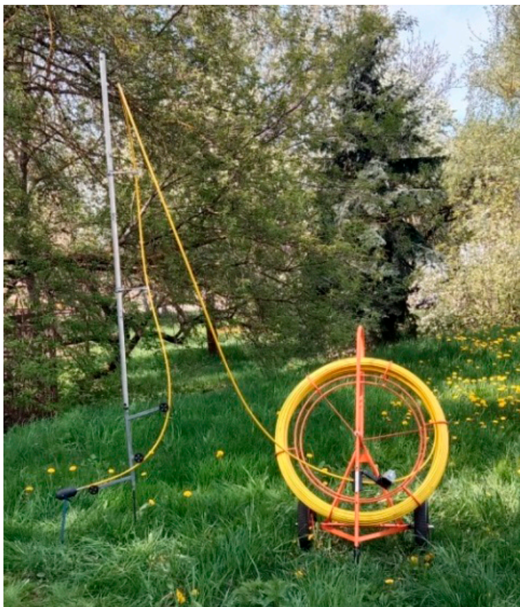
Рис. 3. Штанга направляющая ШН-4 со вставленным в нее упругим стержнем устройства ОД-100
