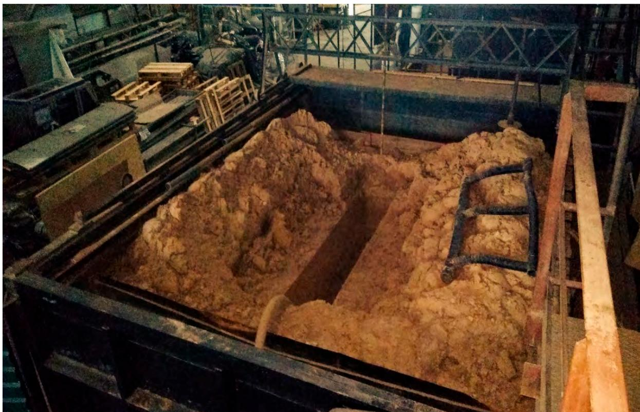
Рис. 5. Устройство модели колонки-поглотителя в грунтовой лотке
