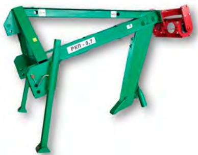
В РУП «Институт мелиорации» разработан рыхлитель-кратователь почвы с ограничителем глубины рыхления РКП-0,7 для полосового глубокого рыхления-кратования почвы на глубину до 70 см.
