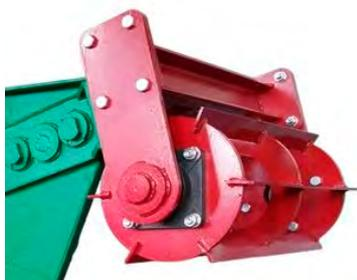
РКП-0,7 производит полосовое глубокое рыхление-кратование почвы. Для отвода избытков воды в РКП-0,7 имеется съемный на цепи дренир диаметром 90 мм. Ограничение глубины рыхления почвы до 70 см в РКП-0,7 осуществляется с помощью ограничителя, который к нему подсоединяется.
