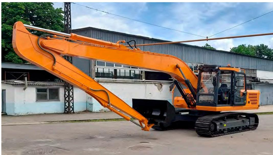
Рис. 2. Экскаватор AMKODOR XC231LR с удлиненным рабочим оборудованием
