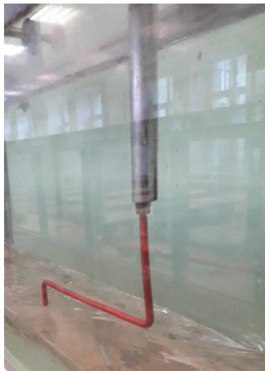
Рис. 2. Проведение замеров уровня воды в гидравлическом лотке (исследуемый материал – оргстекло)
