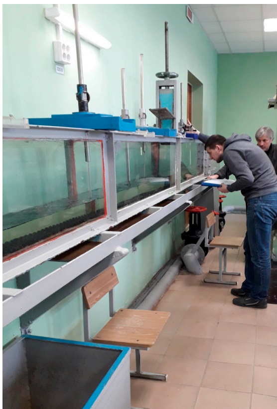
Рис. 3. Проведение замеров уровня воды в гидравлическом лотке (исследуемый материал – профилированная мембрана без покрытия фильтрующим геотекстилем слева, с покрытием – справа)
