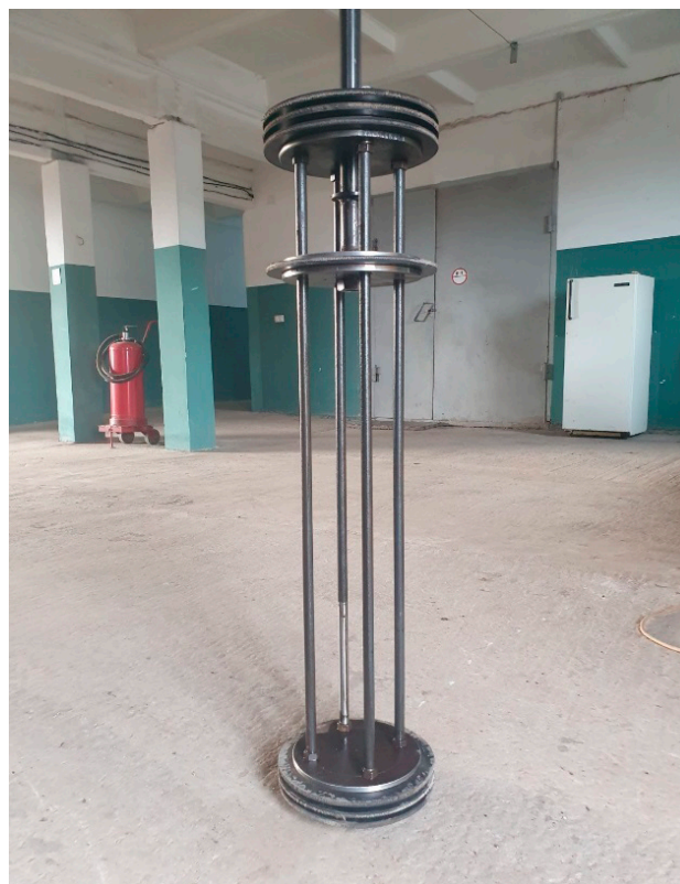
Рис. 1. Схема установки (а) и общий вид скважинного устройства (б) для реагентной обработки фильтра на основе метода линейного свабивания в замкнутых камерах: 1 – сваб; 2 – шток; 3 – верхний пакер; 4 – нижний пакер; 5 – направляющие стержни; 6 – водоподъемные трубы эрлифта; 7 – массивный груз; 8 – верхний упор; 9 – нижний упор; 10 – шланг для подачи реагента; 11 – емкость для реагента; 12 – лебедка
