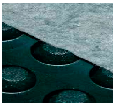
Рис. 10. Геомембрана с геотекстильным 3ФМ, прикрепленным с одной стороны
