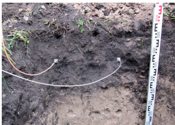
Рис. 5. Проведение экспериментальных исследований по измерению затухания радиосигнала при прохождении его через почву на земельном участке Института мелиорации
