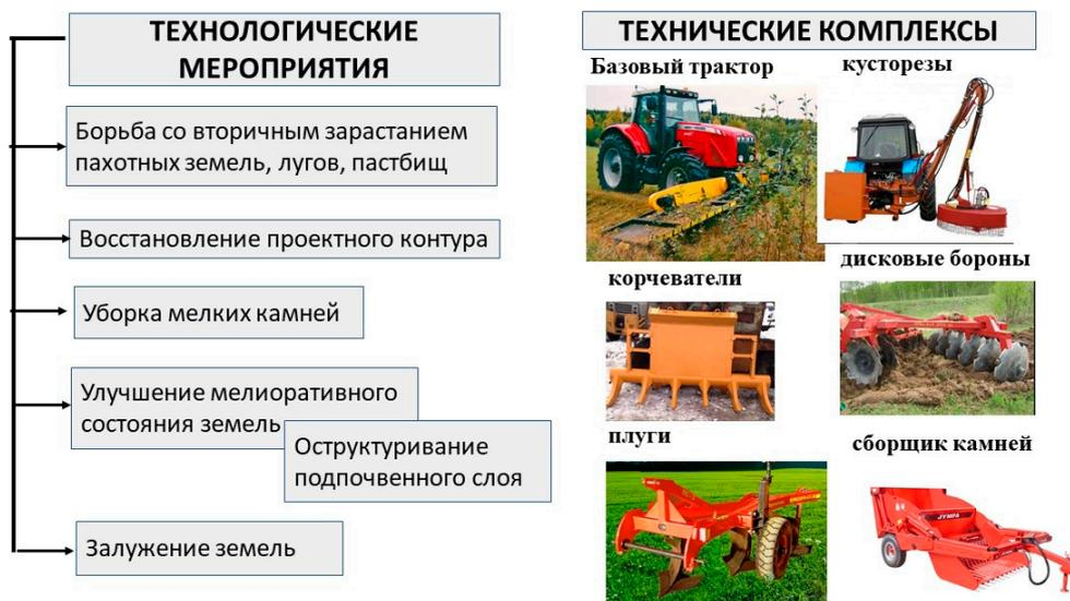
Рис. 3. Технологические мероприятия и технические комплексы обеспечения программы вовлечения в оборот выбывших (неиспользуемых) сельскохозяйственных угодий за счет проведения культуротехнических работ
