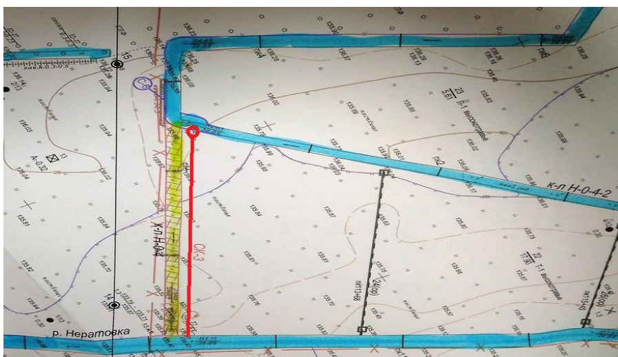
Рис. 6. Схема устройства трубопровода большого диаметра с ликвидацией открытого канала Н-0-4 на экспериментальном варианте 3 мелиоративной системы «Нератовка»
