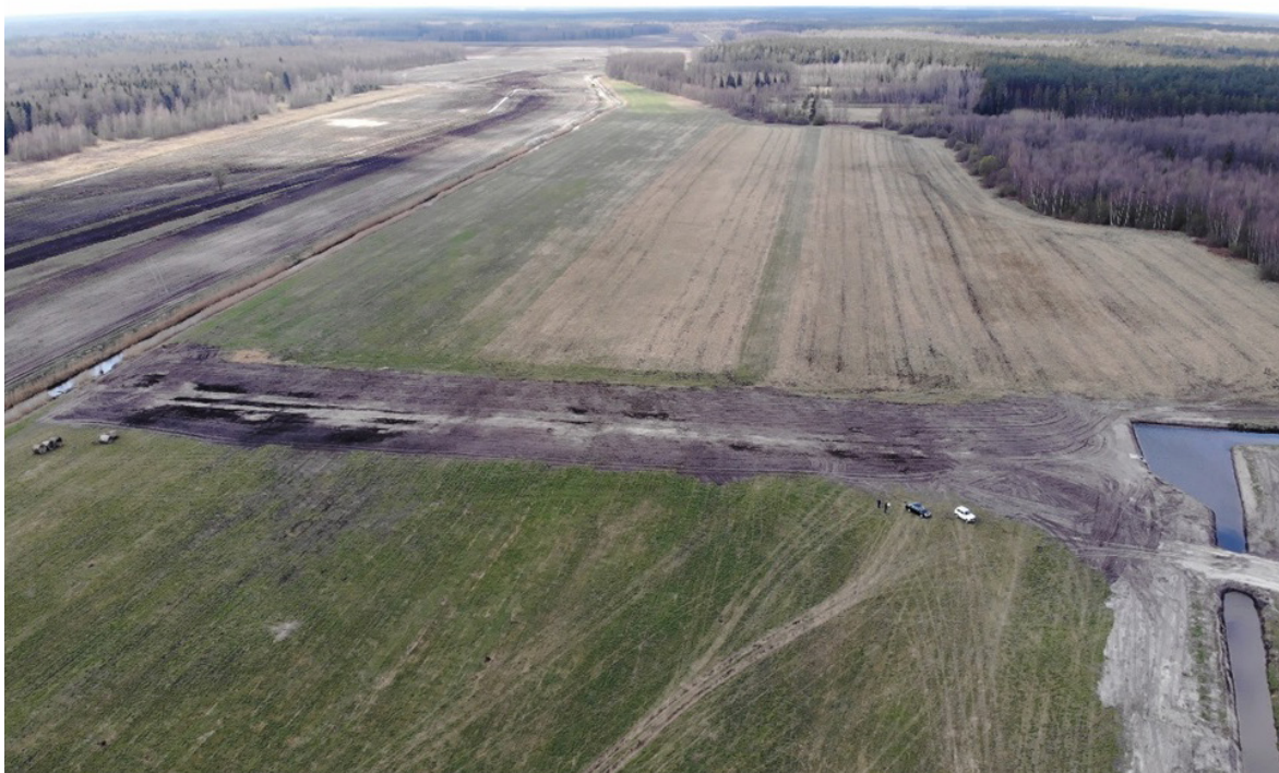
Рис. 7. Фото ликвидированного открытого канала на варианте 3 мелиоративного объекта «Нератовка»
