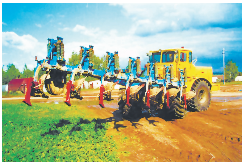
Рисунок 2 – Рыхлители плужной подошвы РПП-20 на плуге ПГП-7-40 в агрегате с трактором К-701
