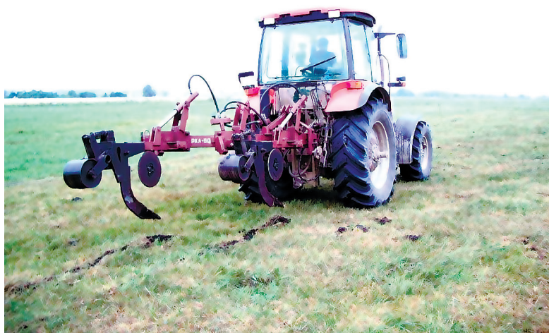
Рисунок 3 – Рыхлительное оборудование РКЛ-50 на базе рамы плуга ППП-3-40Б в агрегате с трактором МТЗ-1221
