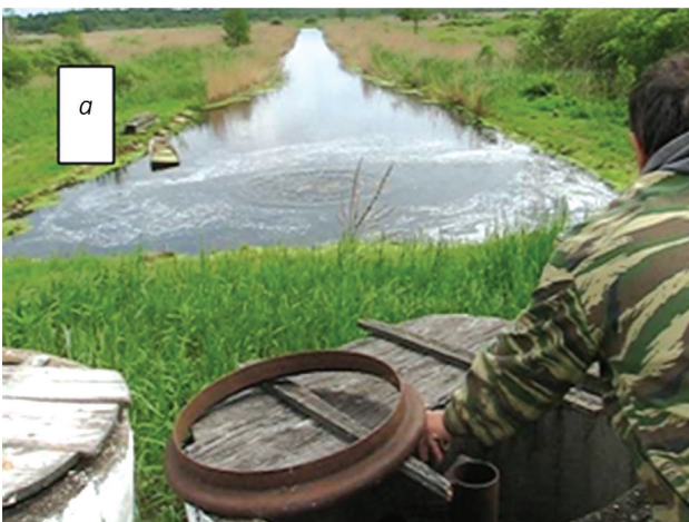
Рисунок 2 – Формирование метки (воздушных пузырей) с помощью кратковременного открытия клапана срыва вакуума в сифонном водосбросном водоводе насосной станции системы «Гало-Ковалевская»
