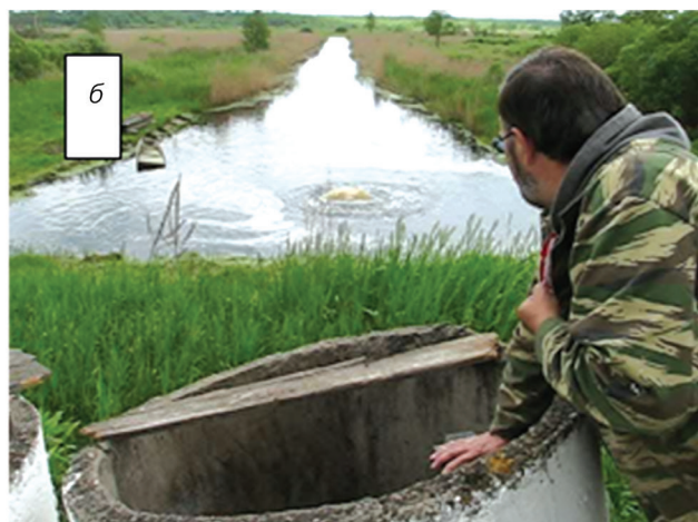
Рисунок 2 – Формирование метки (воздушных пузырей) с помощью кратковременного открытия клапана срыва вакуума в сифонном водосбросном водоводе насосной станции системы «Гало-Ковалевская»
