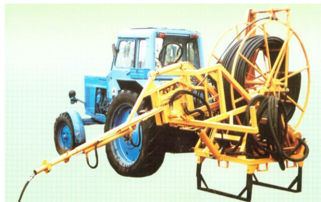
Рисунок 3 – Установка промывки дренажа УПД-120
