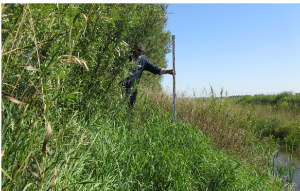
Рисунок 2 – Варианты двухразовой и одноразовой окоски (к-л Б-3-0-6-1, правый берег; на переднем плане вариант двухразовой окоски, на заднем – одноразовой; 04.08.2011 г.)
