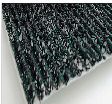
Рис. 7. Геомат, скрепленный с одной стороны геотекстильным ЗФМ
