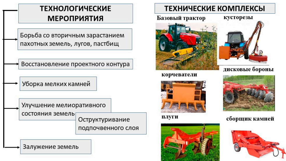
Рис. 3. Технологические мероприятия и технические комплексы обеспечения программы вовлечения в оборот выбывших (неиспользуемых) сельскохозяйственных угодий за счет проведения культуротехнических работ
