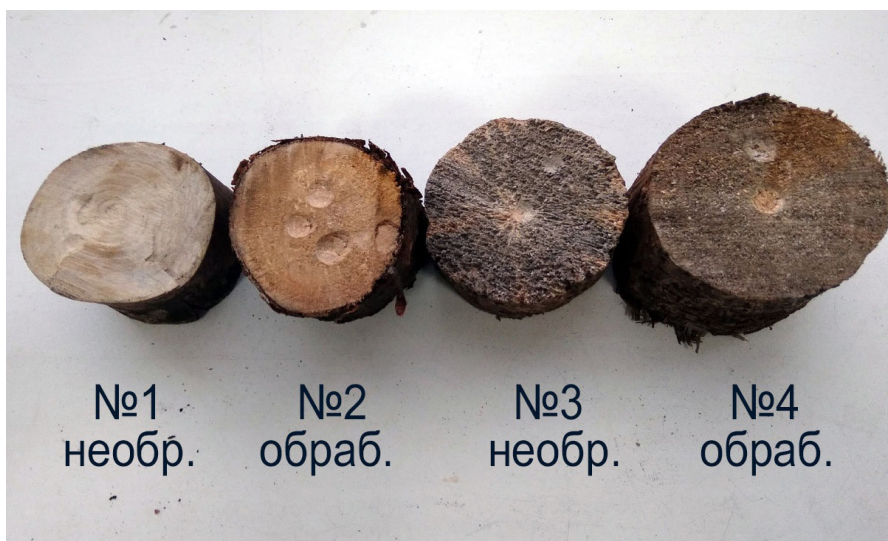
Рис. 3. Образцы после определения твердости по Бринеллю Образцы 1, 2 – береза, 3, 4 – сосна
