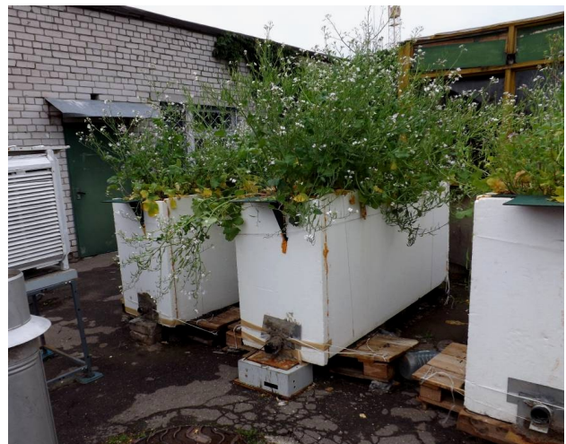
Рисунок 1.– Общий вид на площадку с грунтовыми лотками, в которых заложены модели различных конструкций дренажа и траншейных засыпок в условиях суглинистых грунтов, типичных для Глубокского района Витебской области
