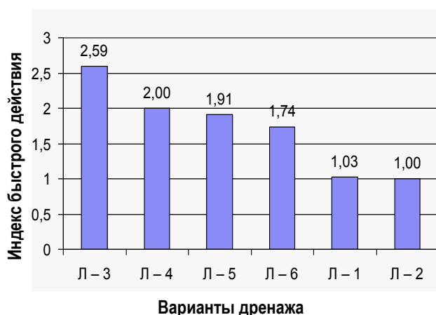
Рисунок 7.– Ранжированный ряд индексов относительного быстродействия вариантов дренажа при отводе ливневых осадков
