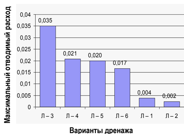
Рисунок 8. – Ранжированный по максимальному отводимому расходу (л/с с 1 м) ряд вариантов конструкции дренажа для слабопроницаемых суглинистых почв
