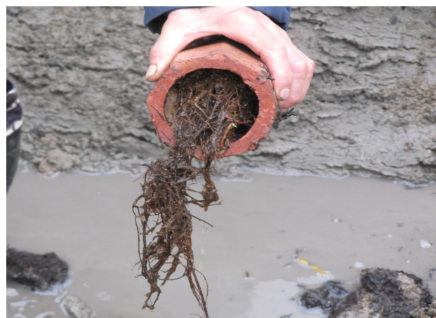
Рисунок 9. – Закупорка дренажной трубки корнями растений
