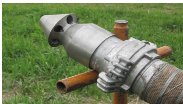
Рисунок 8 – Установка головки промывочной на пожарном рукаве
