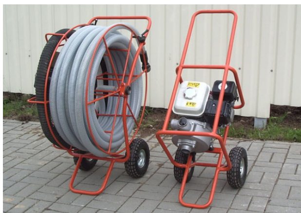
Рисунок 1 – Установка промывки устьевого части коллектора УПК-30
