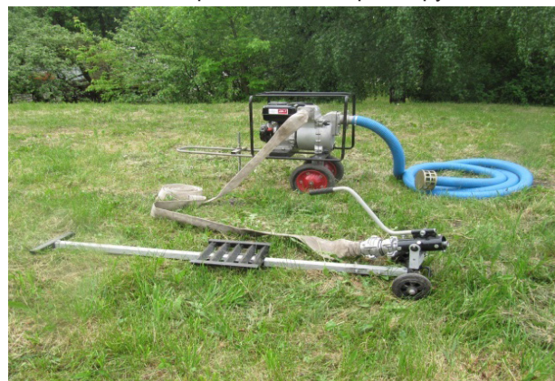
Рисунок 2 – Установка промывки трубопроводов УПТ-75
