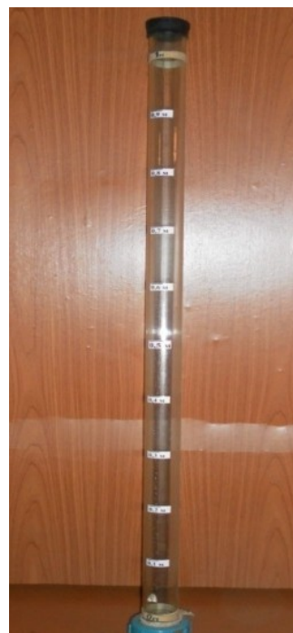
Рисунок 5 – Лабораторная установка для исследования гидравлической крупности семян рапса
