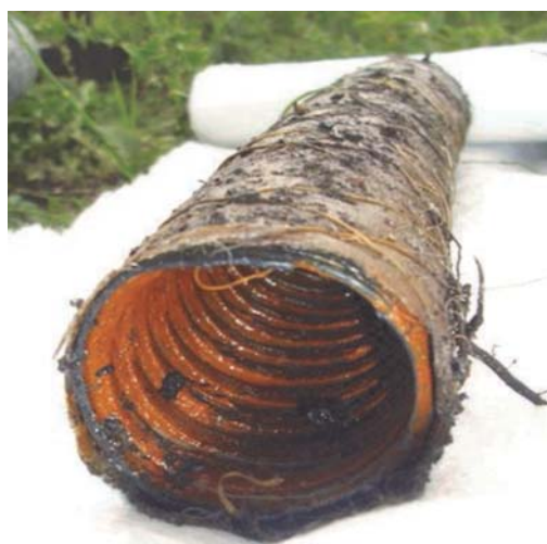
Рисунок 1 – Образец трубы, взятой с одиночной дрены № 26 объекта «Волма», срок эксплуатации 1,5 года
