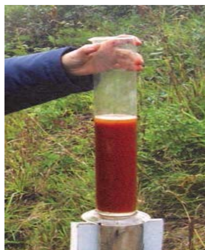
Рисунок 2 – Вода с избыточным содержанием закисного железа из дрены №26 объекта «Волма»
