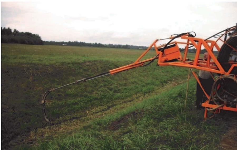
**Рис.5 – Промывка дренажных коллекторов установкой УПД-120 с применением направляющего устройства конструкции ОАО «Пинский завод средств малой механизации».**
