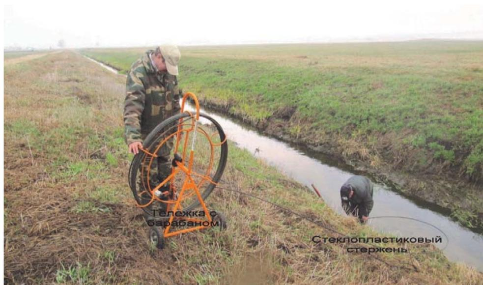
**Рисунок 1 – Оценка внутреннего состояния устьевой и прилегающей частей дренажного коллектора с помощью ОД-100.**
