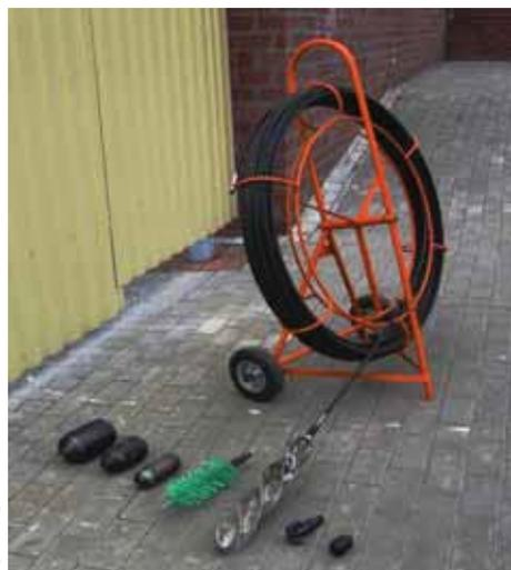
**Рис. 1 – Устройство ОД-100 со сменным оборудованием**
