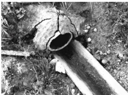
**Рис. 1. Разрушенный стык асбестоцементной устьевой трубы с асбестоцементным лотком дренажного устья через месяц после строительства (объект ремонта – «ВЭХ» Сенненского района)**
