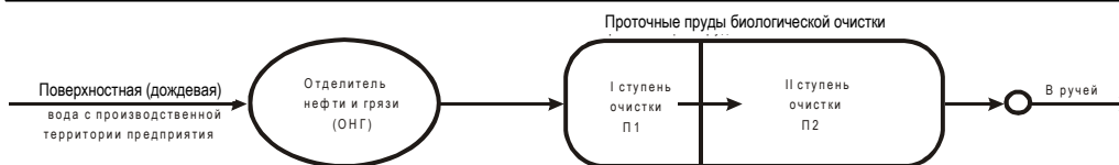
Рис. 1. Схема очистки поверхностных (дождевых) стоков
