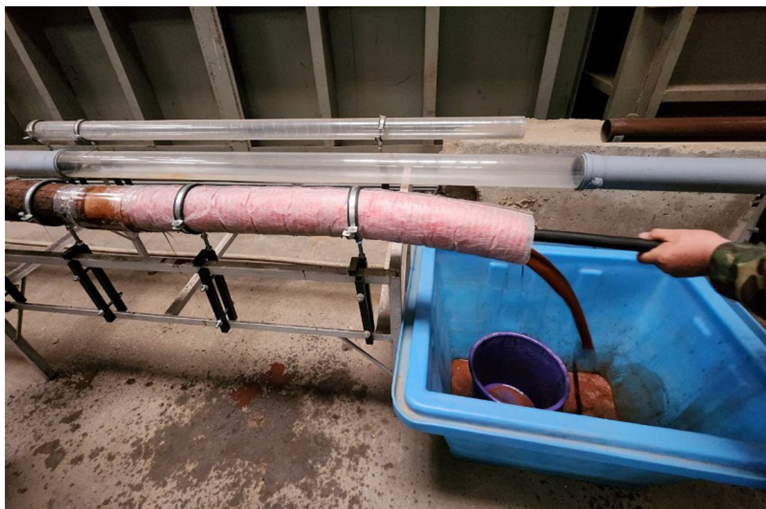
Рис. 1. Установка для моделирования промывки дренажа: 1–2 – общий вид элементов установки; 3 – процесс моделирования промывки
