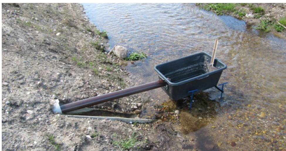
Рис. 9. Оборудование для определения параметров потока воды, вытекающей из коллектора
