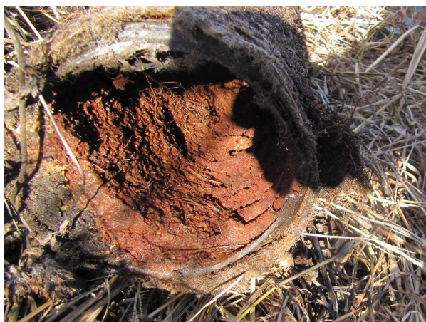
Рис. 2. Заохривание с заилением внутренней полости дрены № 103
