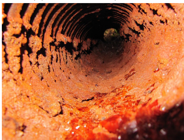
Рис. 4. Заиление и заохривание дрены № 111
