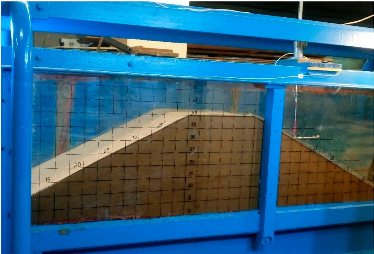
Рис. 1. Лоток с размещенной моделью плотины
