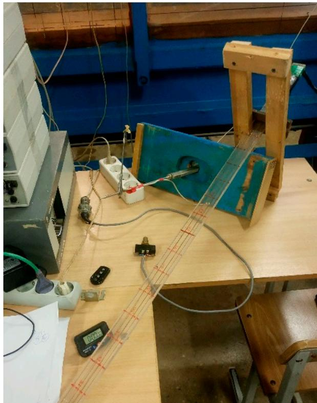
Рис. 3. Кондуктометрический уровнемер
