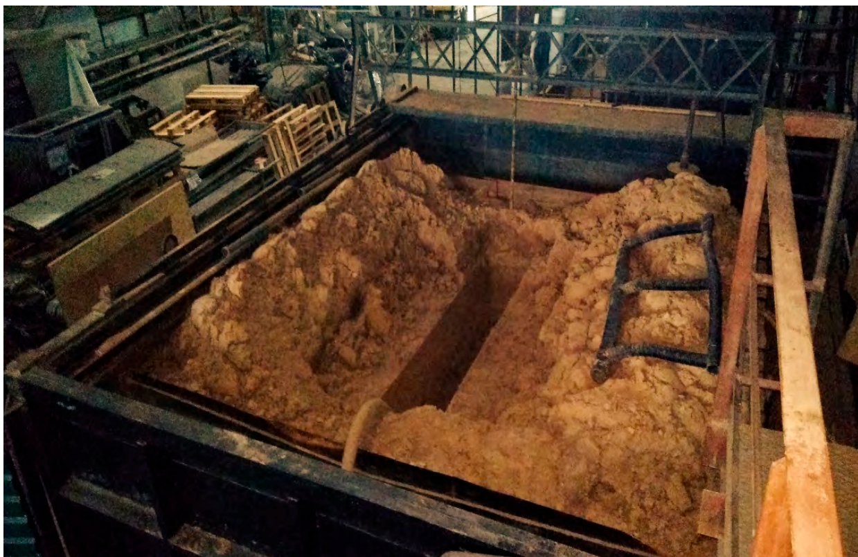
Рис. 5. Устройство модели колонки-поглотителя в грунтовой лотке
