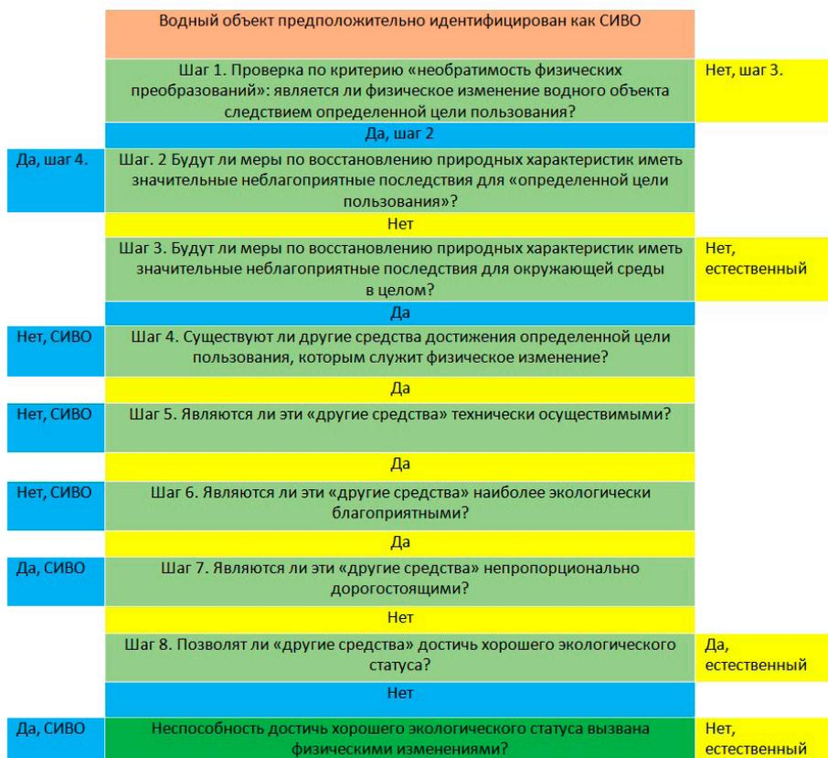
Рисунок. Алгоритм пошагового определения возможности отнесения водного объекта к СИВО
