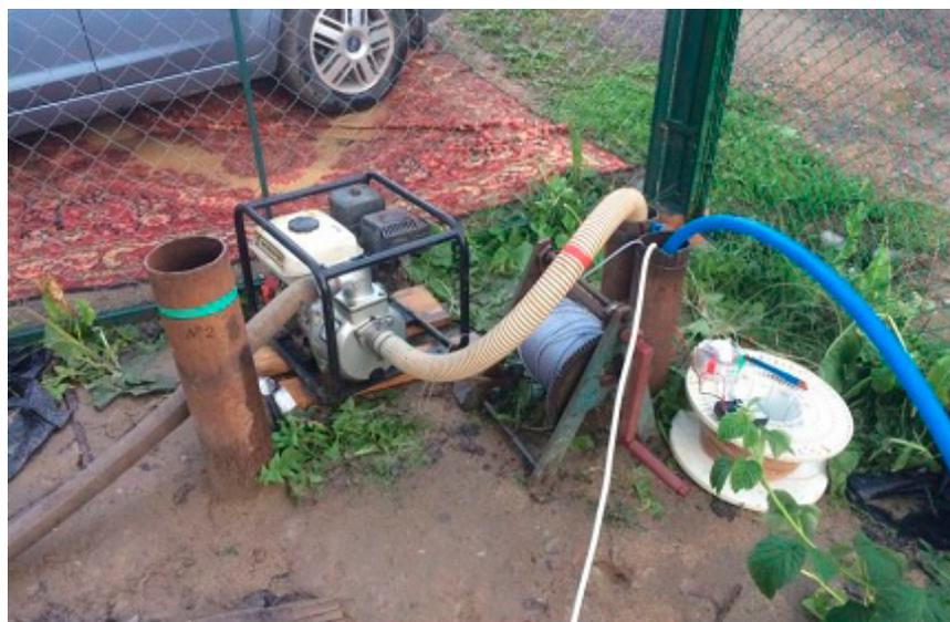
Рис. 3. Полевые испытания скважины двухколонной конструкции
