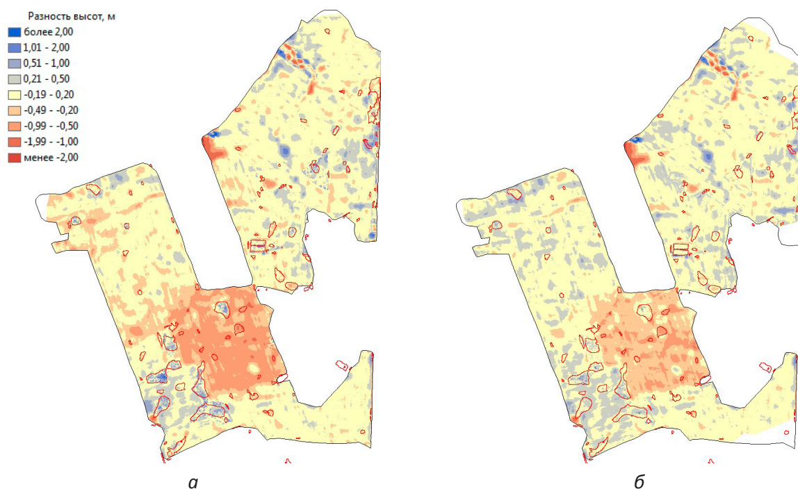
Рис. 8. Растры разностей высот ЦМР (объект «Барсуки»): а – ЦМР АФС – ЦМР Топо; б – ЦМР ВЛС – ЦМР Топо
