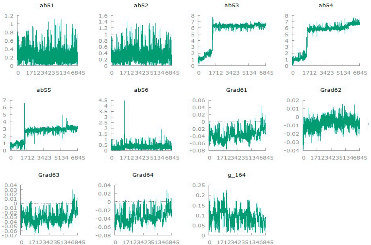
Рис. 2. Графики изменения углов, трещин и показаний инклинометра на различных глубинах в точке VI ( ab )
