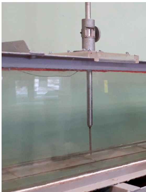
Рис. 2. Проведение замеров уровня воды в гидравлическом лотке (исследуемый материал – оргстекло)
