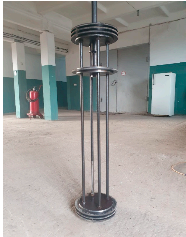
Рис. 1. Схема установки (а) и общий вид скважинного устройства (б) для реagentной обработки фильтра на основе метода линейного свабивания в замкнутых камерах: 1 – сваб; 2 – шток; 3 – верхний пакер; 4 – нижний пакер; 5 – направляющие стержни; 6 – водоподъемные трубы эрлифта; 7 – массивный груз; 8 – верхний упор; 9 – нижний упор; 10 – шланг для подачи реагента; 11 – емкость для реагента; 12 – лебедка
