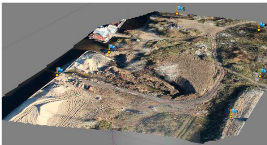
Рис. 8. Трехмерная ЦМР модель прибрежной зоны водохранилища [16, 17]
