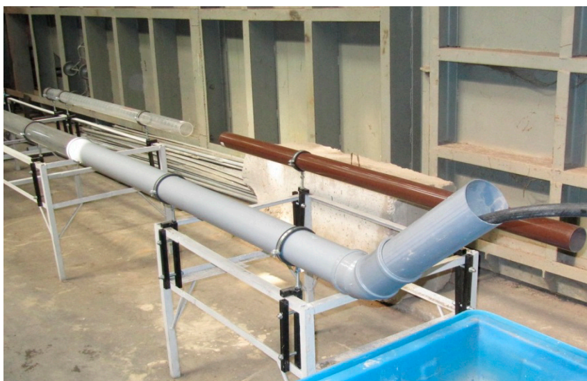
Рис. 8. Общий вид установки для определения динамического напора
